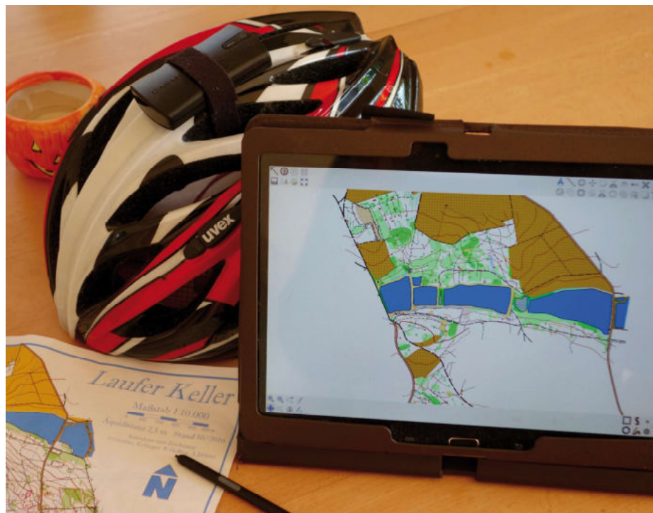
Das Starterset zur Kartenaufnahme: Fahrradhelm mit aufgeklebtem Garmin-GLO, Tablet und die fertige Karte.
